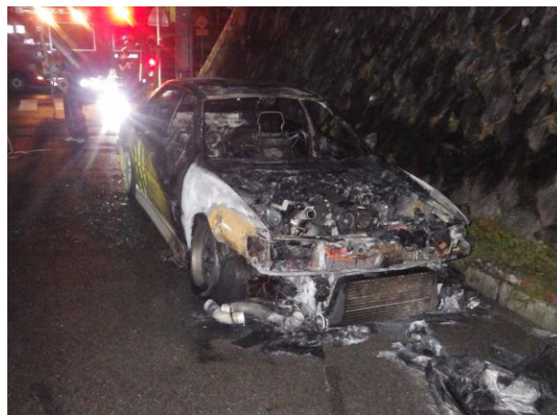
機関部の焼損状況
