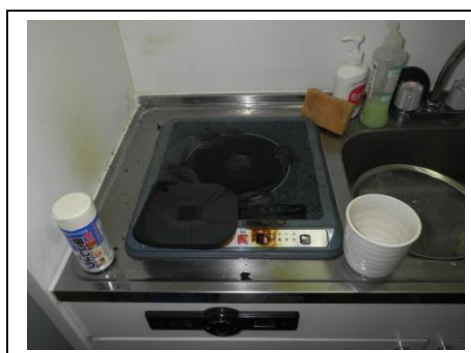
電気コンロが燃えた状況
