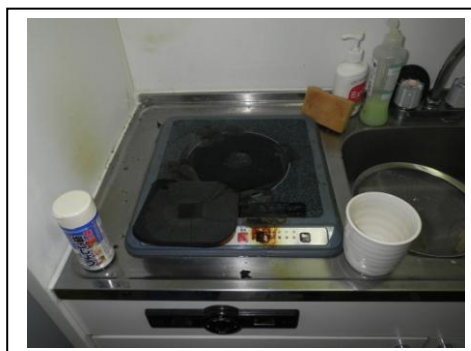
電気コンロが燃えた状況
