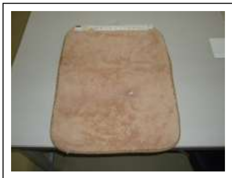
マットが焦げた状況
