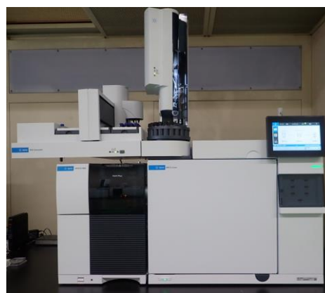
ガスクロマトグラフ質量分析計 (フェノール類等の測定)
