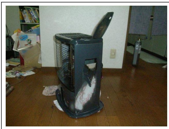
(石油ストーブ 外観の焼損状況)
