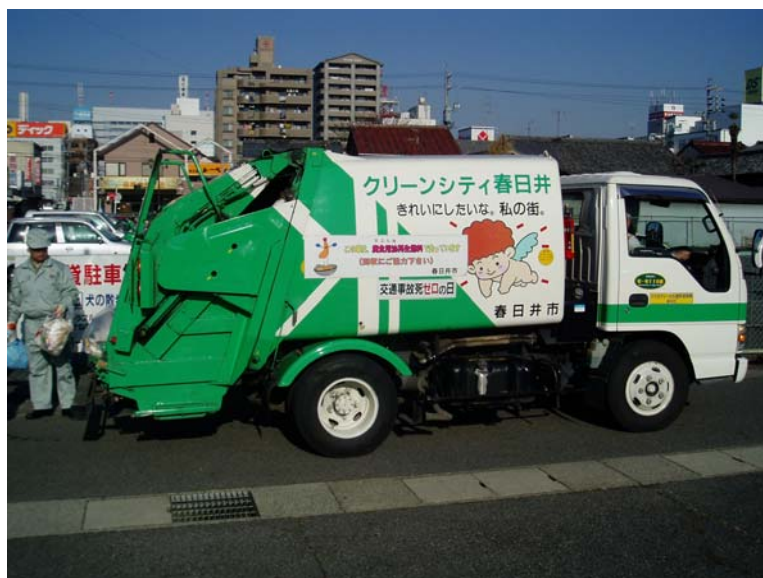
天ぷら油を燃料にしているパッカー車（直営収集）
