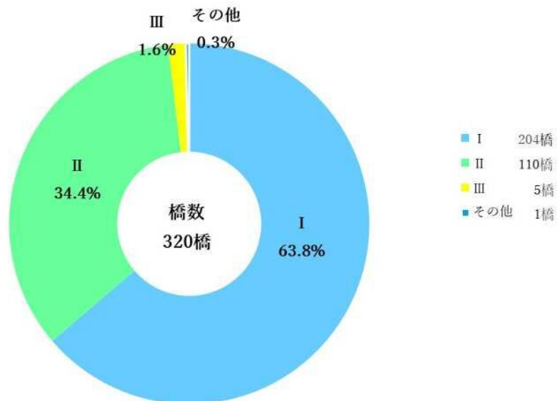
図-2.5 計画対象橋梁の直近点検結果別の割合
