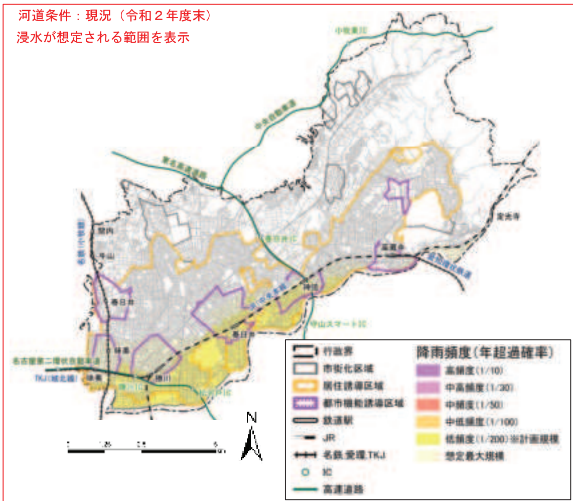
【図 8-7 庄内川水系 国管理河川からの氾濫を想定した水害リスクマップ】
