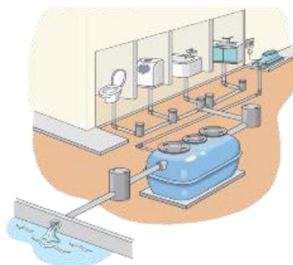
合併処理浄化槽
