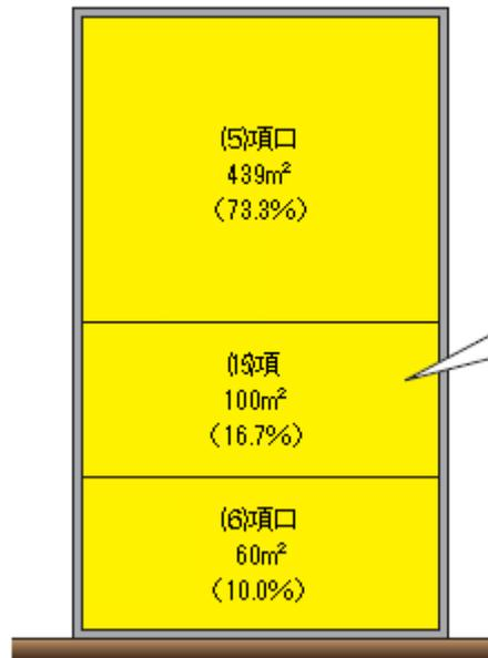
政令第21条第1項第3号の規定により、防火対象物全体に自動火災報知設備を設置する。
