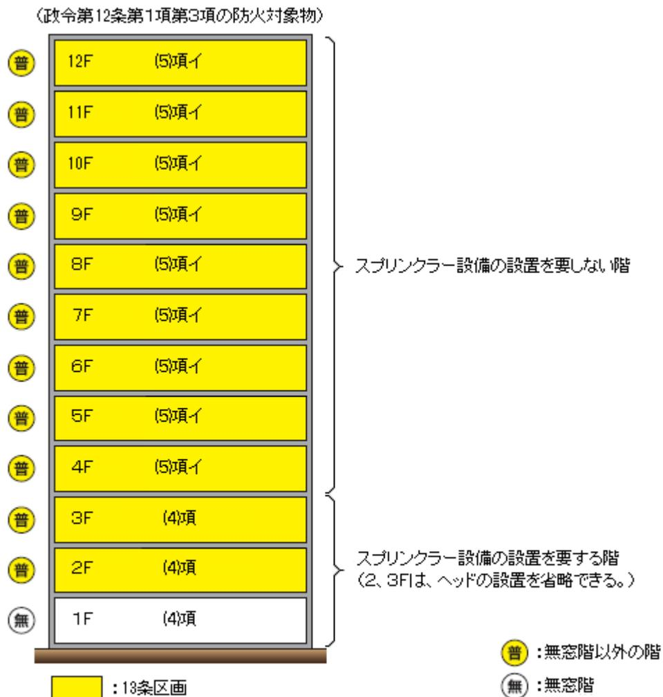
（2)項及び(4)項に掲げる防火対象物は、13条区画した場合であっても、スプリンクラー設備の設置を要する部分から除外できないものとされているが、省令第13条第3項第11号の規定により、ヘッドの設置を省略できる部分とする。
