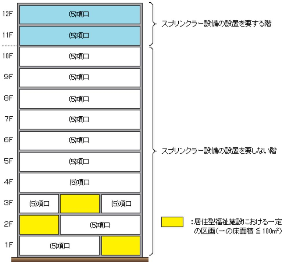
ただし、次のいずれかに該当する階は、スプリンクラー設備の設置が必要となる。
