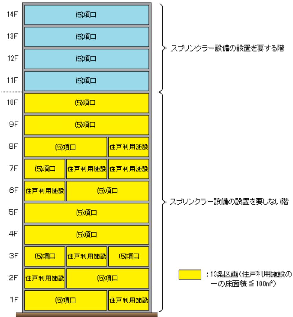
ただし、次のいずれかに該当する階は、スプリンクラー設備の設置が必要となる。
