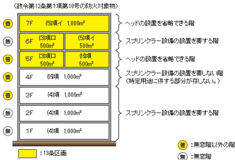
スプリンクラー設備の設置基準の床面積
