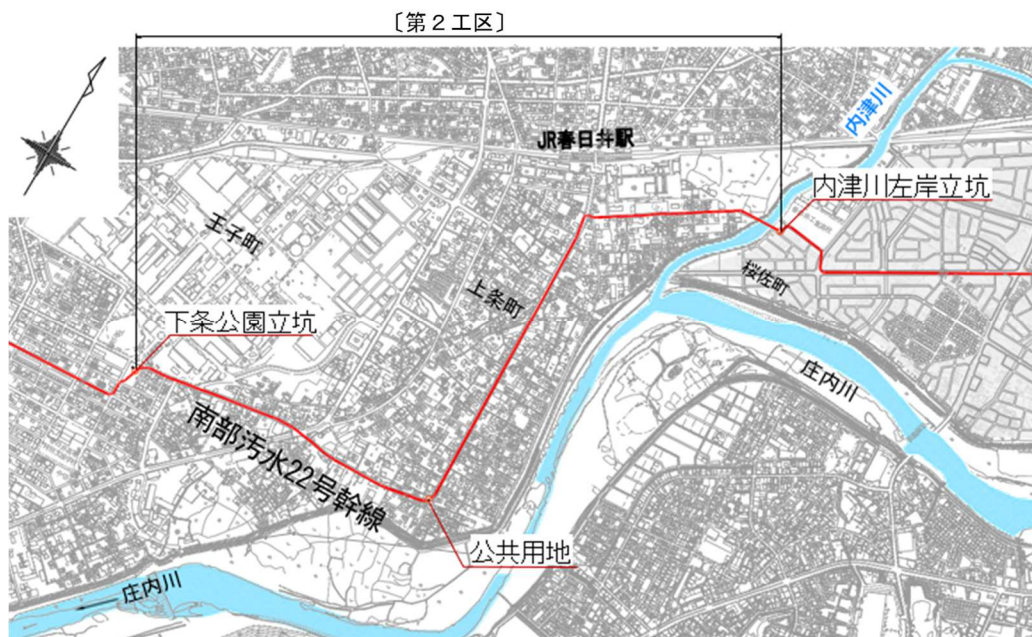
図 2-1 南部汚水22号幹線[第2工区] (工事用地)
