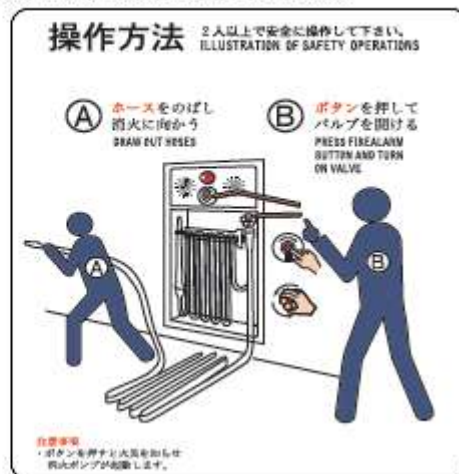
〔加圧送水装置の起動装置が自動火災報知設備のP型発信機と兼用する場合の例〕
